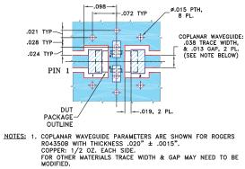
2. BOTTOM SIDE OF THE PCB IS CONTINUOUS GROUND PLANE.
